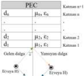
Şekil 1. Mikrodalga soğurucu yapısı
